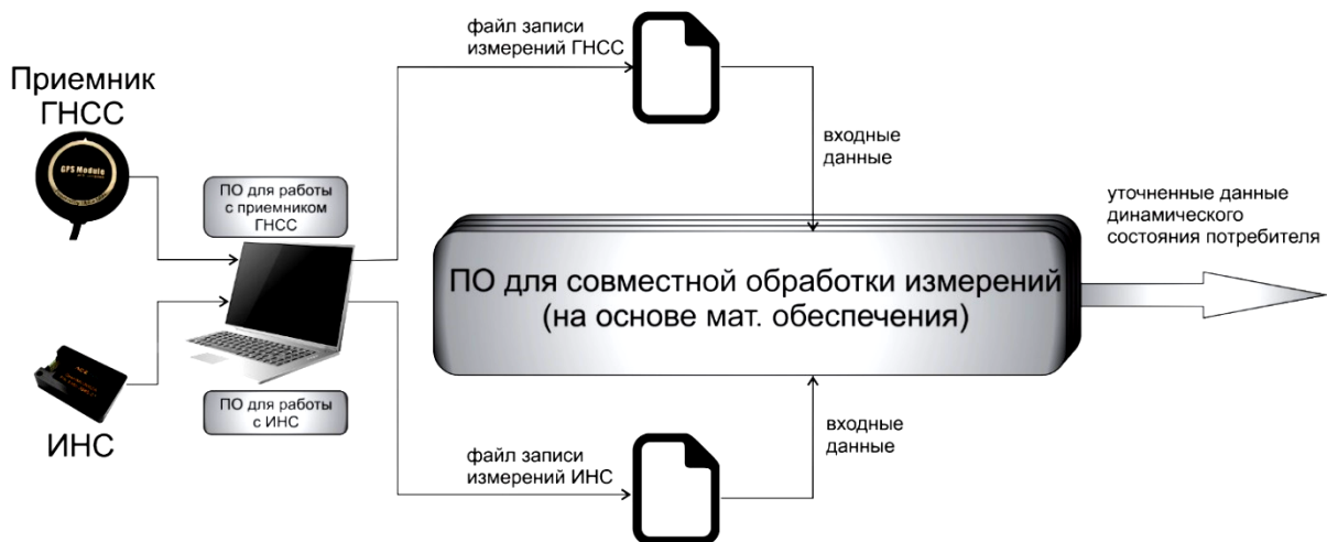
Рисунок 1 – Структура обработки данных в макетном образце ГИСНС
