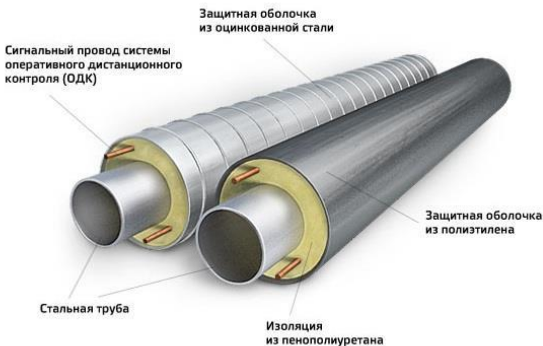
Рисунок 1 - Трубы с проводной системой ОДК
