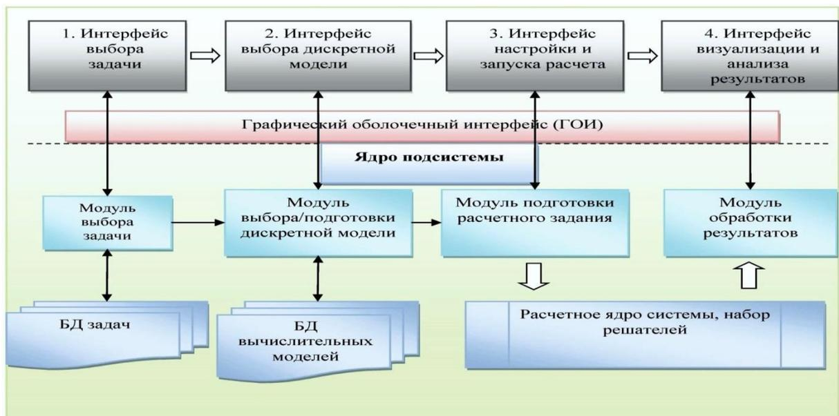
Рисунок 3 – Структурная схема подсистемы вычислительного эксперимента
