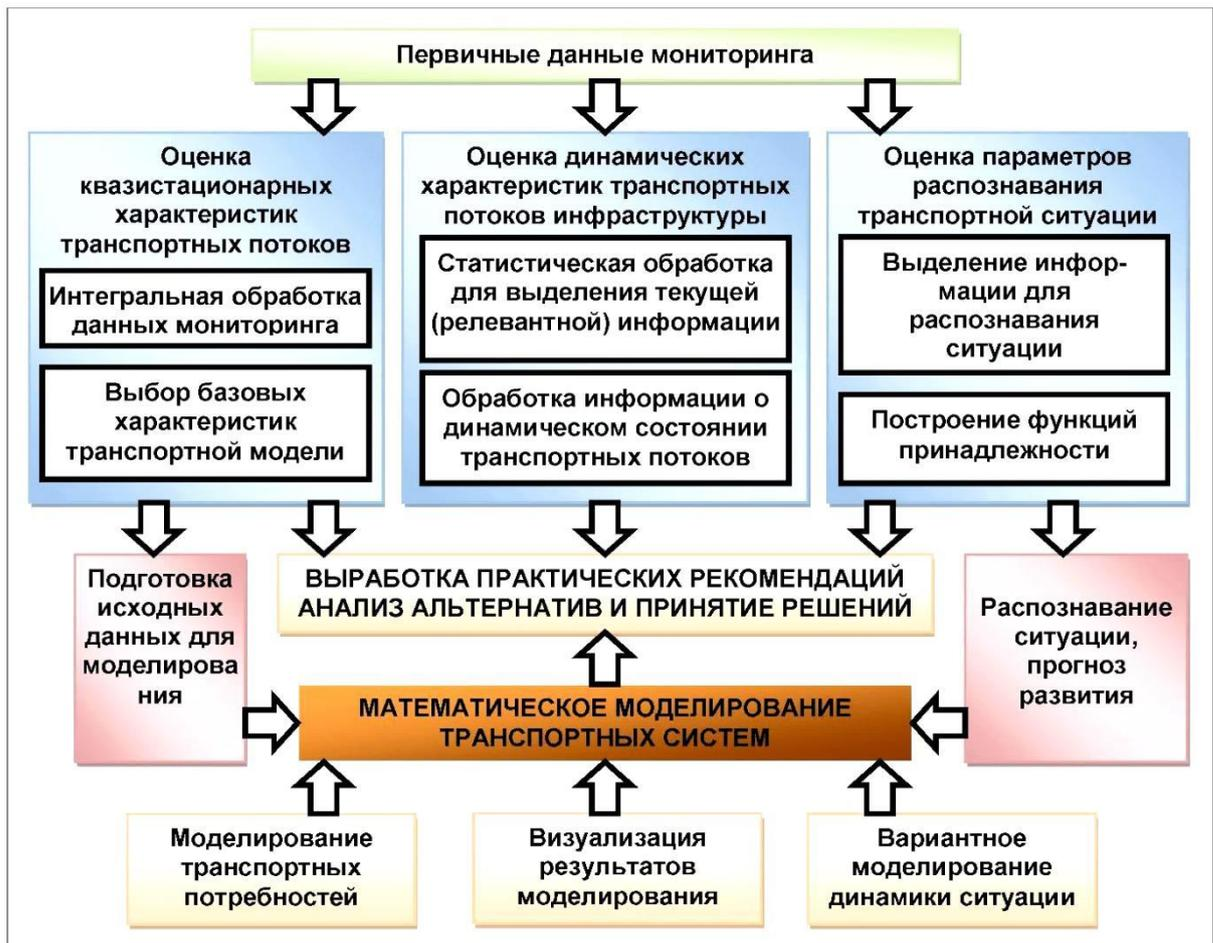
Рисунок 1 – Схема информационно-аналитического обеспечения принятия решений при управлении транспортными потоками
