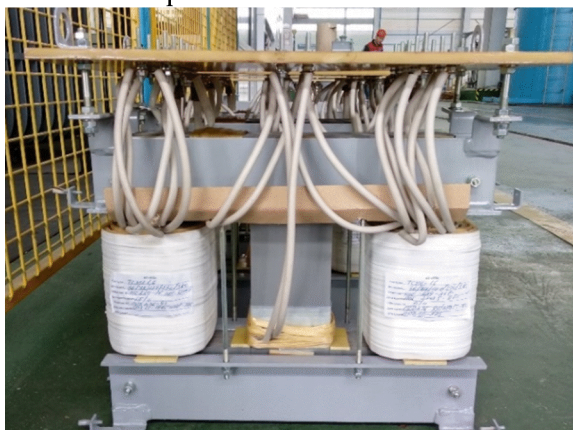
Рисунок 7 - Общий вид фазы модели на трехстержневом магнитопроводе
