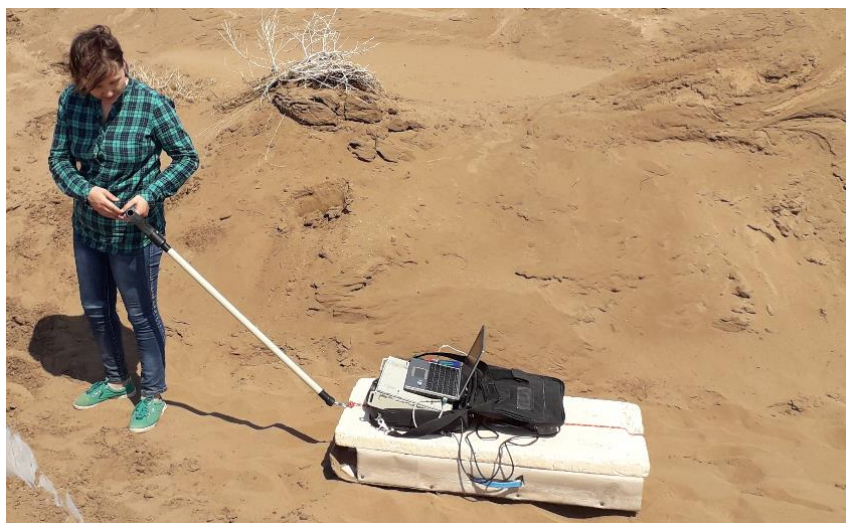
Сурет 1 - Георадар "Зонд-12e"
