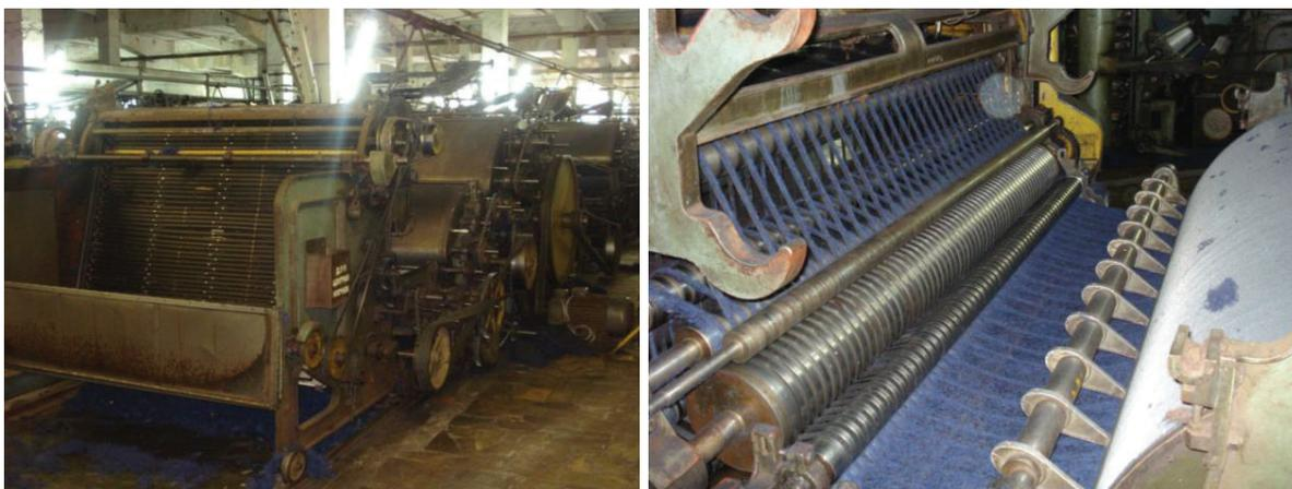
Рисунок 1 - Общий вид чесального аппарата и его ровничной каретки
