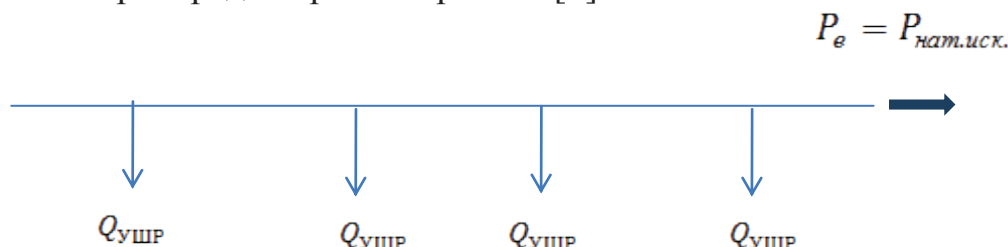
Рисунок 2 - Схема распределения УШР вдоль дальней электропередачи
