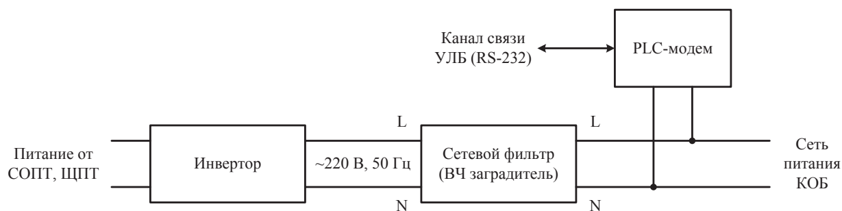
Рисунок 3 – Схема подключения сетевого фильтра
