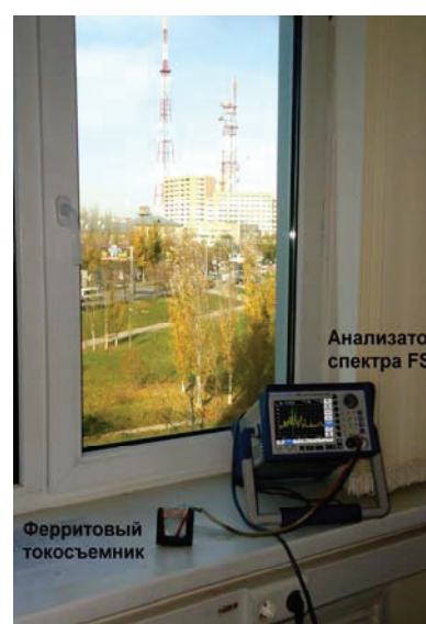
Рисунок 4 - Условия измерения уровня падающего поля U_{Епад}
