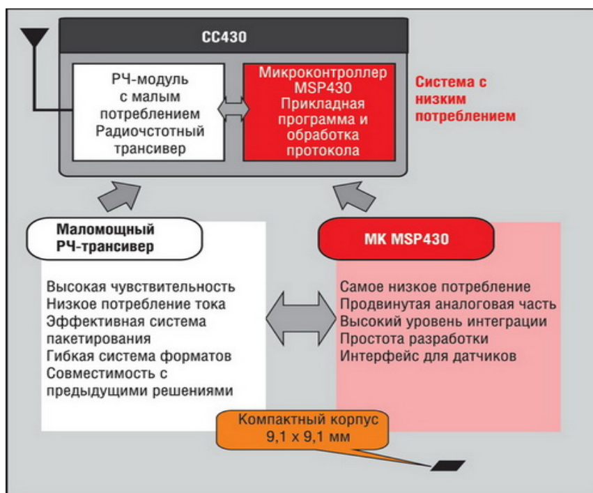
Рисунок 1 - Структурная схема CC430
