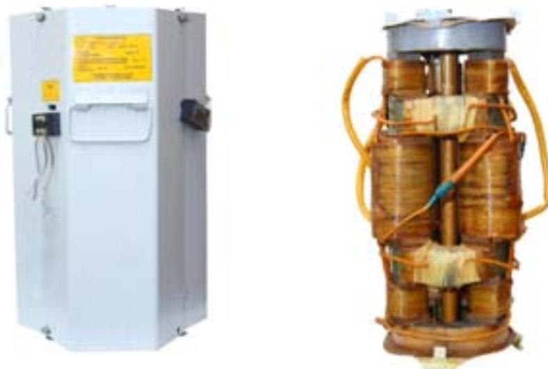
Рисунок 2 - Внешний вид физической модели трансформатора с регулированием напряжения под нагрузкой
