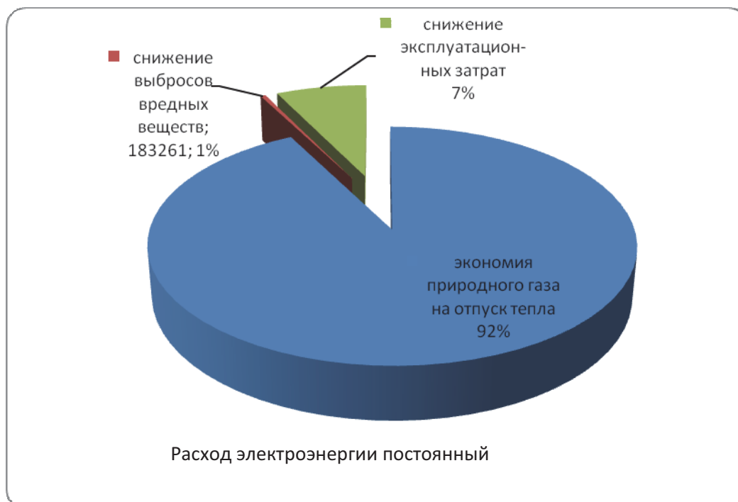
Рисунок 2 – Экономический эффект с ростом КПД на 4,5% при замене 69-ти котлов
