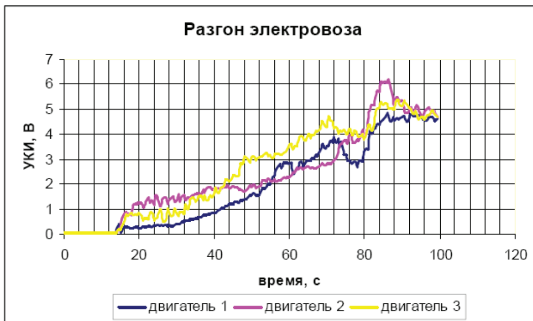
Рисунок 6 - Сигнал УКИ снятый с трех двигателей в режиме разгона
