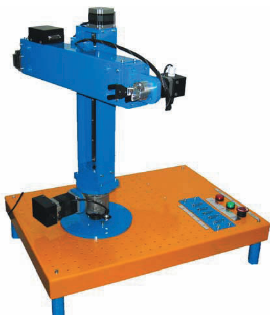
Рисунок 6 – Робот, собранный из модулей конструкторского набора
