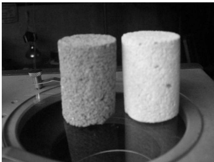
Рисунок 5 – Пористая керамика для подачи воды в плазмотрон
