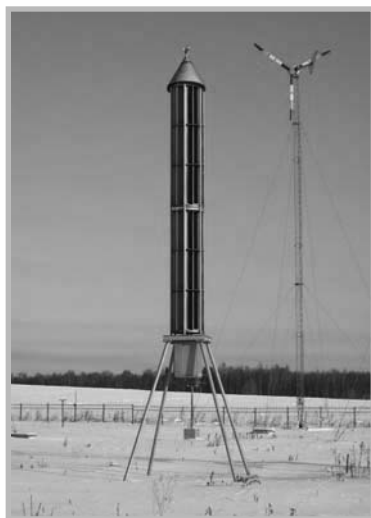
Рисунок 5 - Вертикально-осевая турбина и пропеллерный агрегат мощностью по 2 кВт на испытательном полигоне
